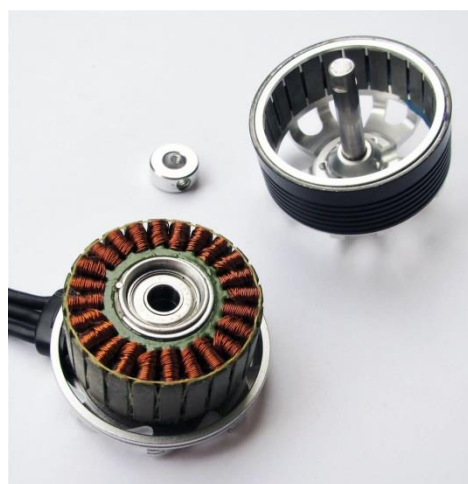
Слика 7. Растављен електромотор
